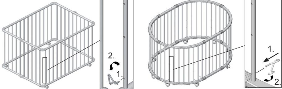
**(SK)** Vyška podlahy sa nastaví podľa telesného vývoja dieťaťa. Výšku nastavte tak, aby dieťa nemohol vypadnúť! Akonáhle dieťa vie sedieť, treba nastaviť podlahu do najnižšej polohy! Ohrádka nesmie byť používaná bez podlahy!
